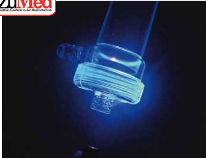
Fluoreszierender Klebstoff: Er wird mit einer UV-LED-Lampe ausgehärtet, um zwei Teile eines Kunststoff-Dialysefilters zu verkleben.
